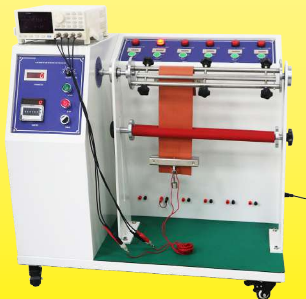
Résistance chauffante flexible en cours d'essai
